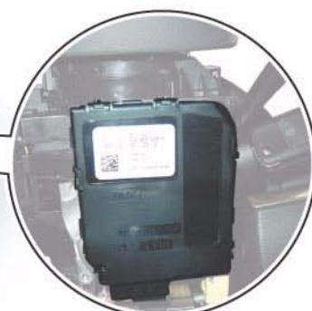
Блок управления рулевой колонки J527,
